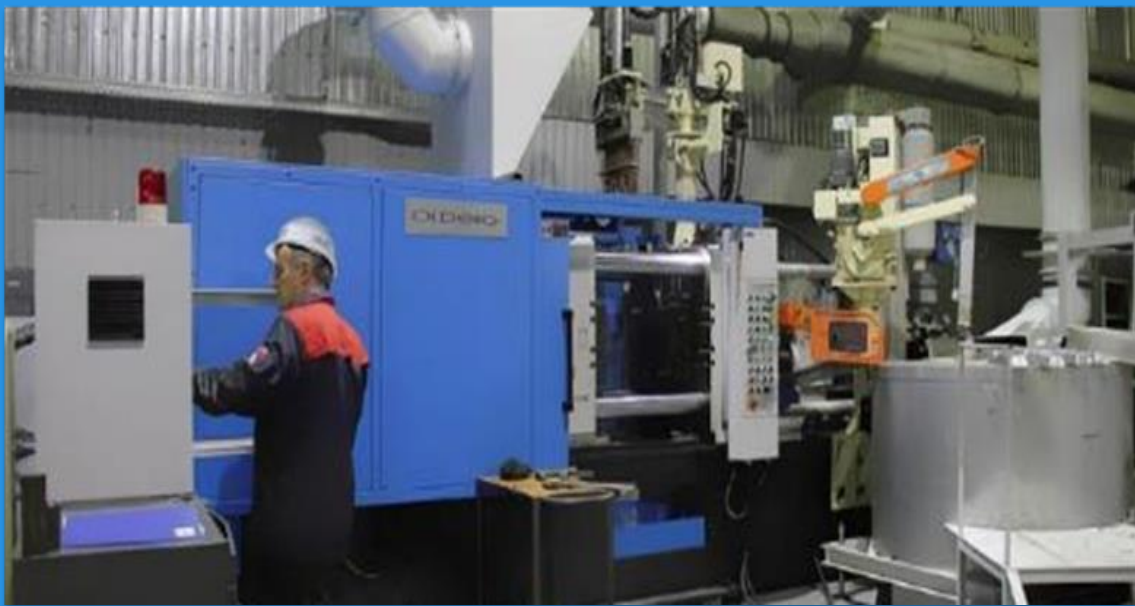
Роботизированный литейный комплекс с ЧПУ. Машина литья под давлением OLDENG C300D Изготовление литейных заготовок из цветных металлов и их сплавов методом литья под давлением.
