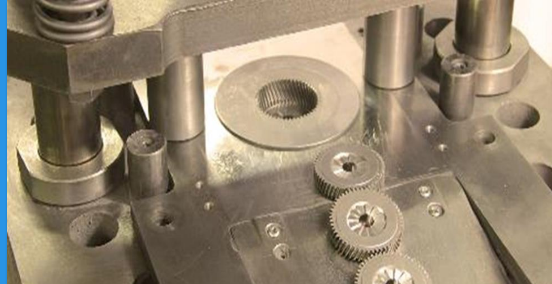
Изготовление высоконагруженных конструктивных деталей методом порошковой металлургии из легированного металлического порошка
