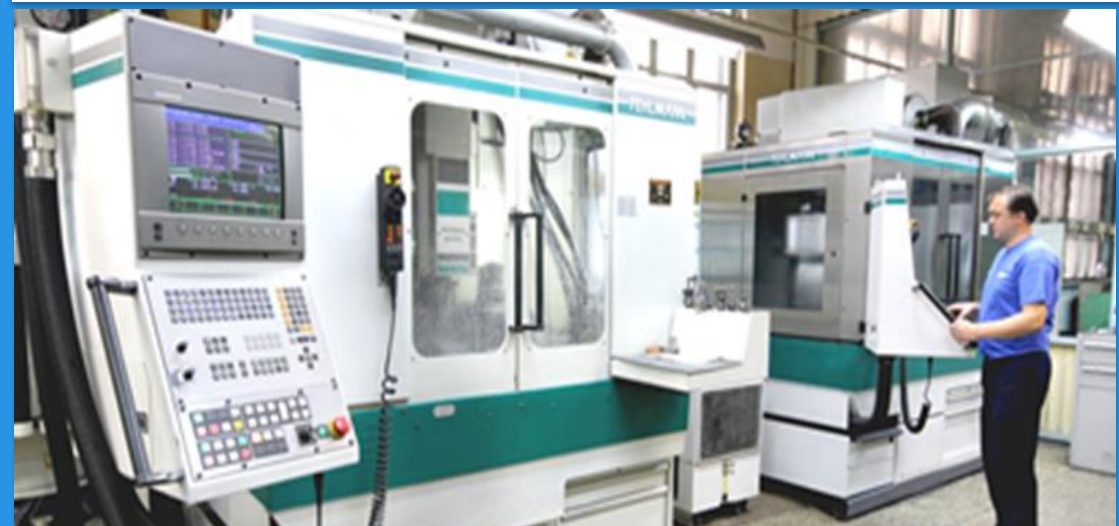
Механическая обработка корпусных деталей из AL-сплавов производится на прецизионных 4-х, 5-ти координатных обрабатывающих центрах Picomax (швейцарской фирмы FEHLMANN)
