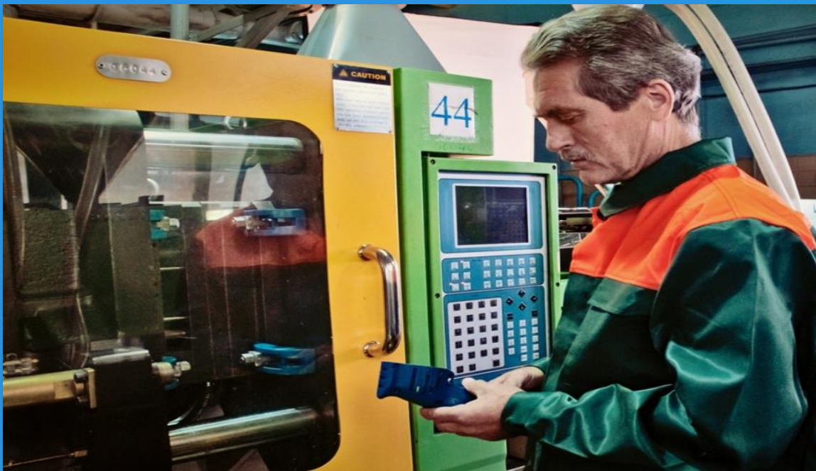
Литье пластмассовых деталей под давлением на современном оборудовании Borsche
