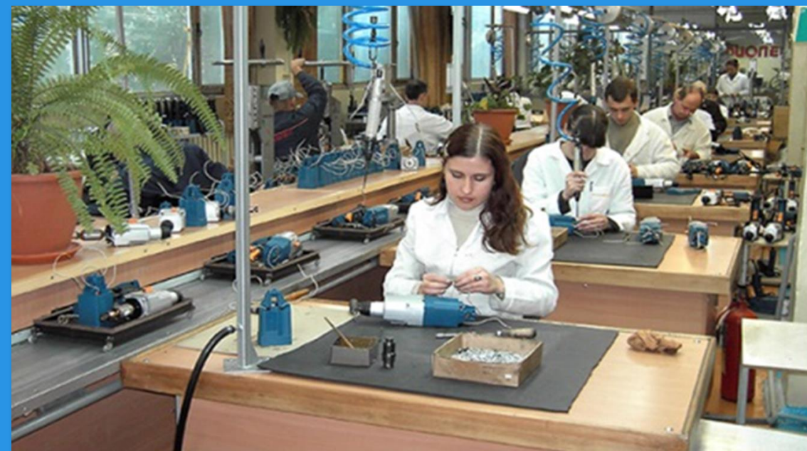
Сборка электроинструмента на конвейерах с заданным тактом
